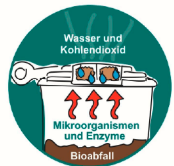
Funktionsweise des Biofilters – Der Deckel schließt dicht und Mikroorganismen im Biofilter zersetzen den Gestank
